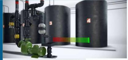
Резервуары-отстойники оснащены специализированным оборудованием для контроля, циркуляции, аэрации радиоактивных стоков.
